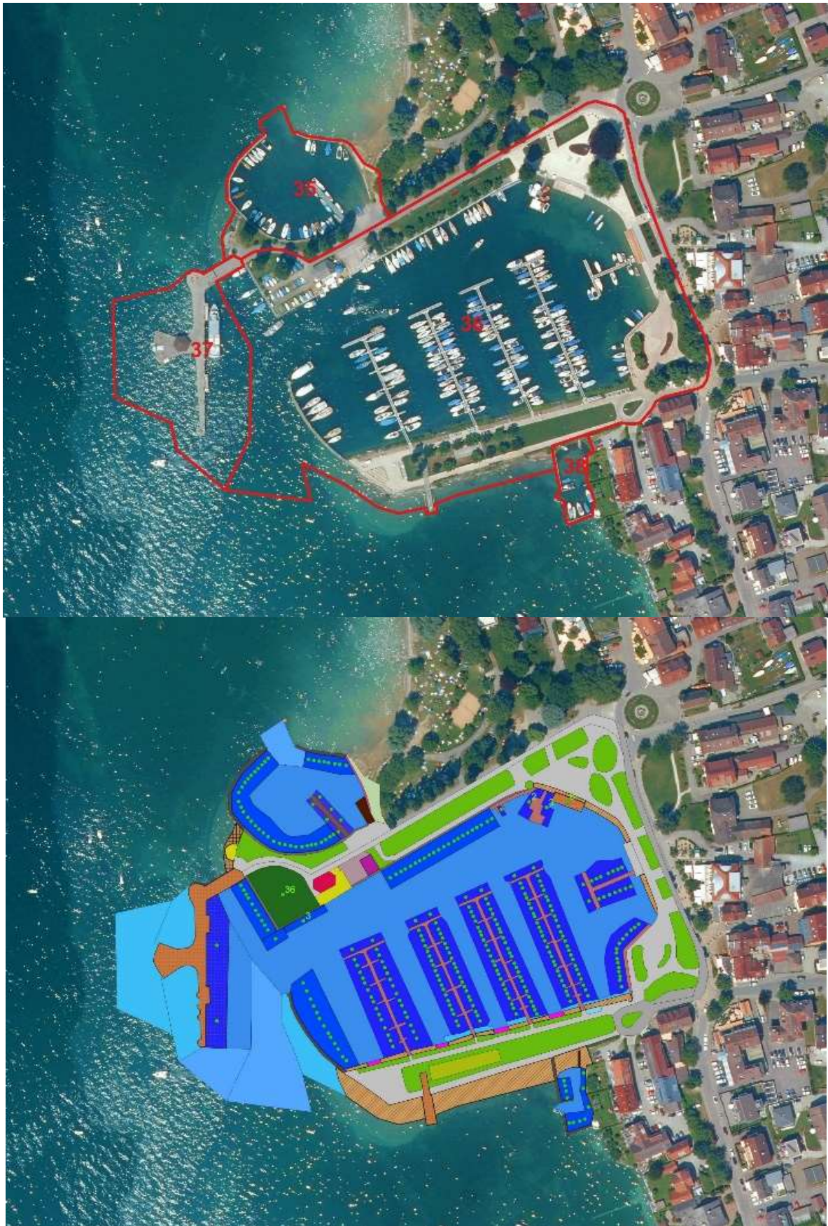
Abb. 4: (a) Hafen Unteruhldingen (Bodensee) mit Fischerhafen (ID 35), Sportboothafen (ID 36), Anlegesteg der Fahrgastschifffahrt (ID 37) und priv. Kleinsthafen (ID 38). Luftbild: LGL Bad.-Württ. (b) flächige Darstellung der Struktur- und Ausstattungselemente (Blau – Wasserflächen, Punkte – Liegeplätze, Grün – Grün- u. Freiflächen).
