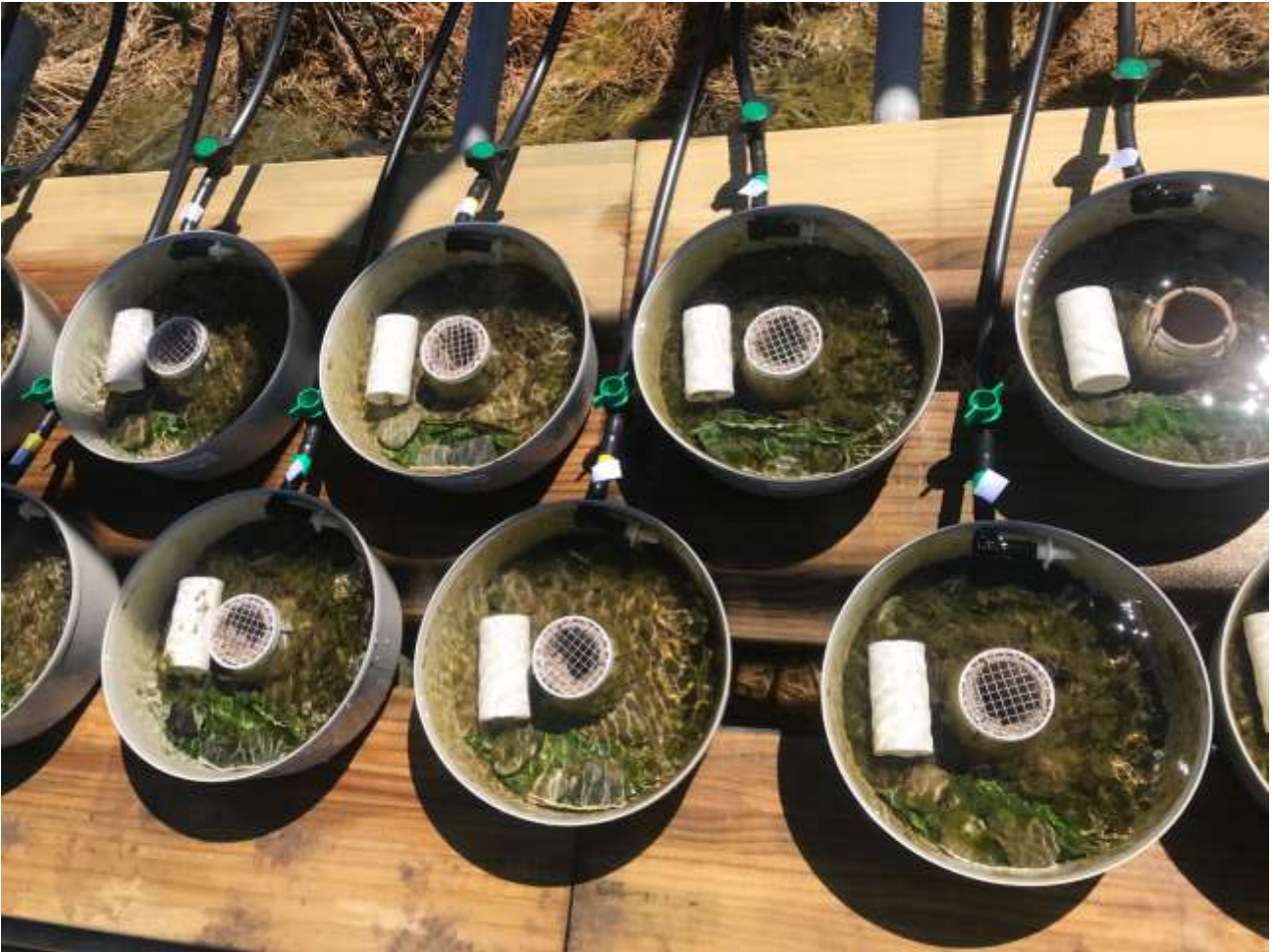
Abbildung 1: Mesokosmen im ExStream-Versuch, gespeist mit Wasser aus dem Kauru. © Julia Hunn
