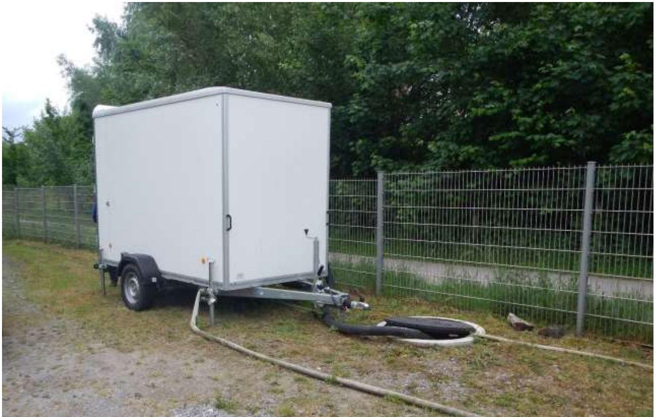
Abbildung 21: Messanhänger mit Zulaufschlauch am Messstandort Emscher km 75,15
