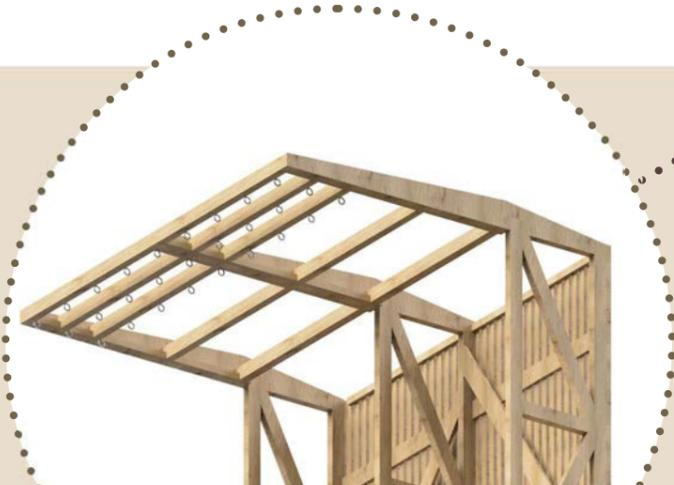
Dachkonstruktion / Befestigung Netz am Dach
