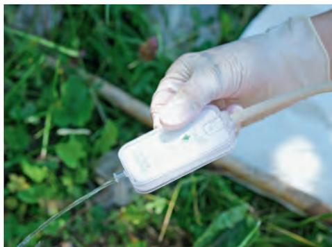
Abb. 44: Die DNA wurde mittels Filtration von Wasser durch feine sterile Filter gesammelt.
